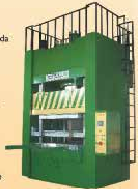
HLP 1000 Ton Kalıp sürücülü hidrolik lastik presi
