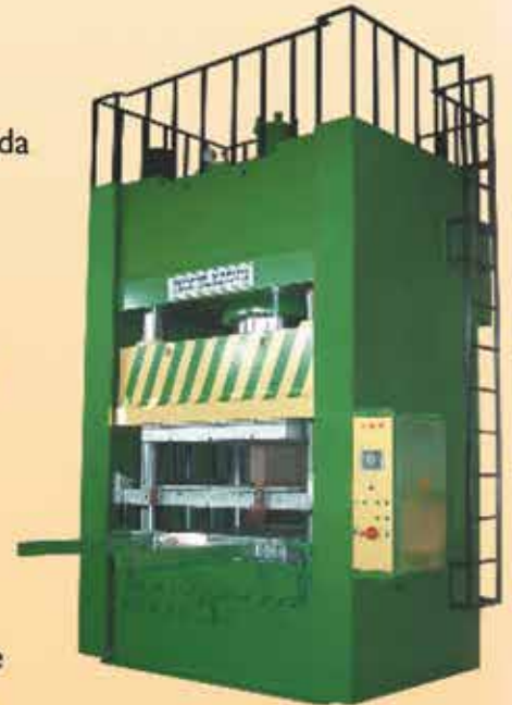
HLP 1000 Ton Kalıp sürücülü hidrolik lastik presi
